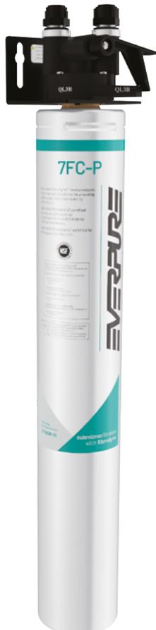
Die Wasserfilteranlage QL3B - 7FC-P wurde zur Reduzierung von PFOA/PFOS, Chlor, Geschmack und Geruch, Mikroplastik und Partikel entwickelt. Sie gewährleistet dabei gleichzeitig eine konstante Durchflussrate von 6,32 l/min. bei über 37.750 Liter. Diese Merkmale können zu einer zuverlässigen und dauerhaften Leistung der Geräte beitragen.
